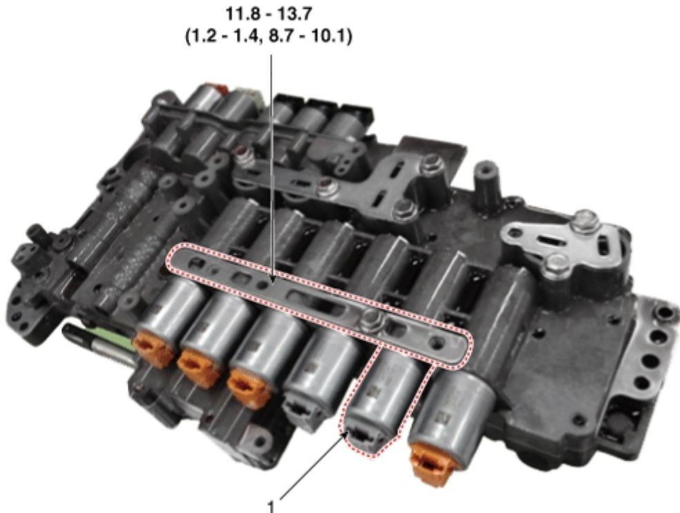
**Tightening torque: N·m (kgf·m, lb·ft)**
